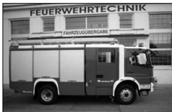
HLF 10/6 (Hilfeleistungslöschfahrzeug 10/6) Mercedes Benz 256 PS Hersteller Rosenbauer
